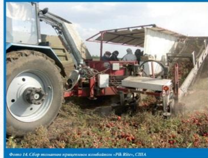
Фото 14. Сбор томатов прицепным комбайном «Pik Rite», США
