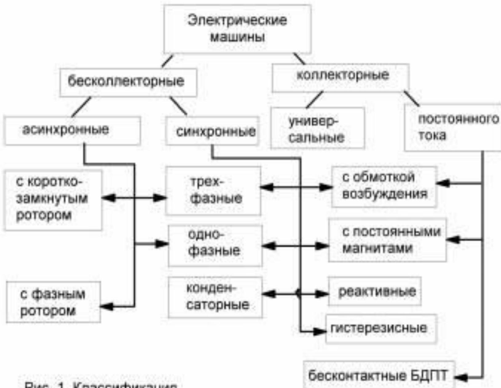
Рис. 1. Классификация электрических машин
