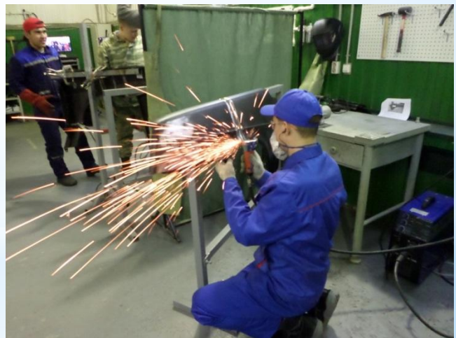
Модуль С «Замена неструктурного элемента кузова» Компетенция «Кузовной ремонт»
