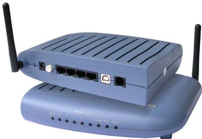
**Точка доступа** – это беспроводная базовая станция, предназначенная для обеспечения беспроводного доступа к уже существующей сети (беспроводной или проводной) или создания совершенно новой *беспроводной сети*. В Перми на сегодня функционирует Wi-Fi точек - 227, из них бесплатных - 171, платных - 56.
