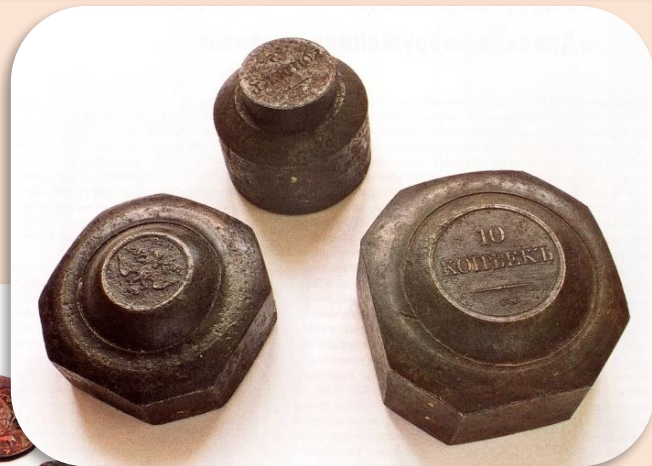
Чеканы (набор маточников и штемпелей) Сузунского монетного двора для изготовления медной монеты.
