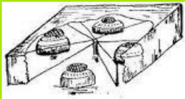
**Уголкового отражатели** предназначены для создания радиолокационных масок и имитации металлических, железобетонных конструкций, а также мостов, плотин, дамб.
