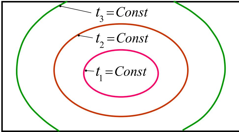
Изотермическая поверхность – это геометрическое место точек с одинаковой температурой.
