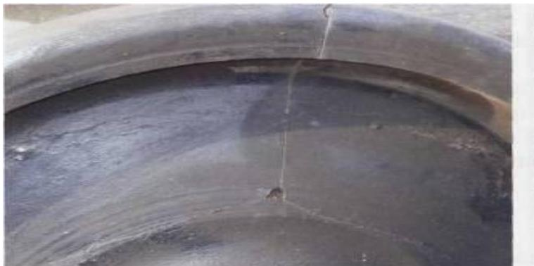
В процессе эксплуатации возникают неисправности колесных пар, некоторые из них:
