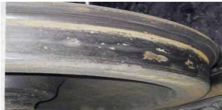
**Выщербины** – выкрашивание металла на поверхности катания
