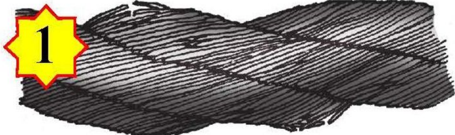
Рисунок 1. Обрывы и смещения проволок каната крестовой свивки
