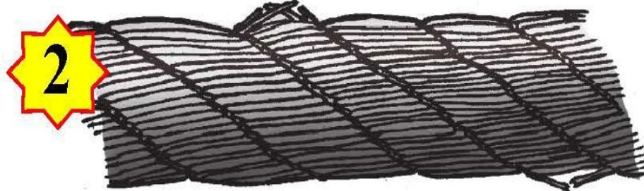
Рисунок 2. Сочетание обрывов с их износом в канате крестовой свивки
