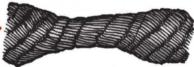
Рисунок 17 Раздавливание участков каната
