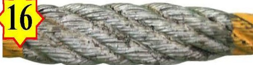
Рисунок 16 Местное увеличение диаметра каната
