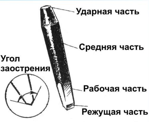
**Рубкой** разделяют заготовку на части, удаляют лишний металл (*припуск*), делают в деталях смазочные канавки и др.
