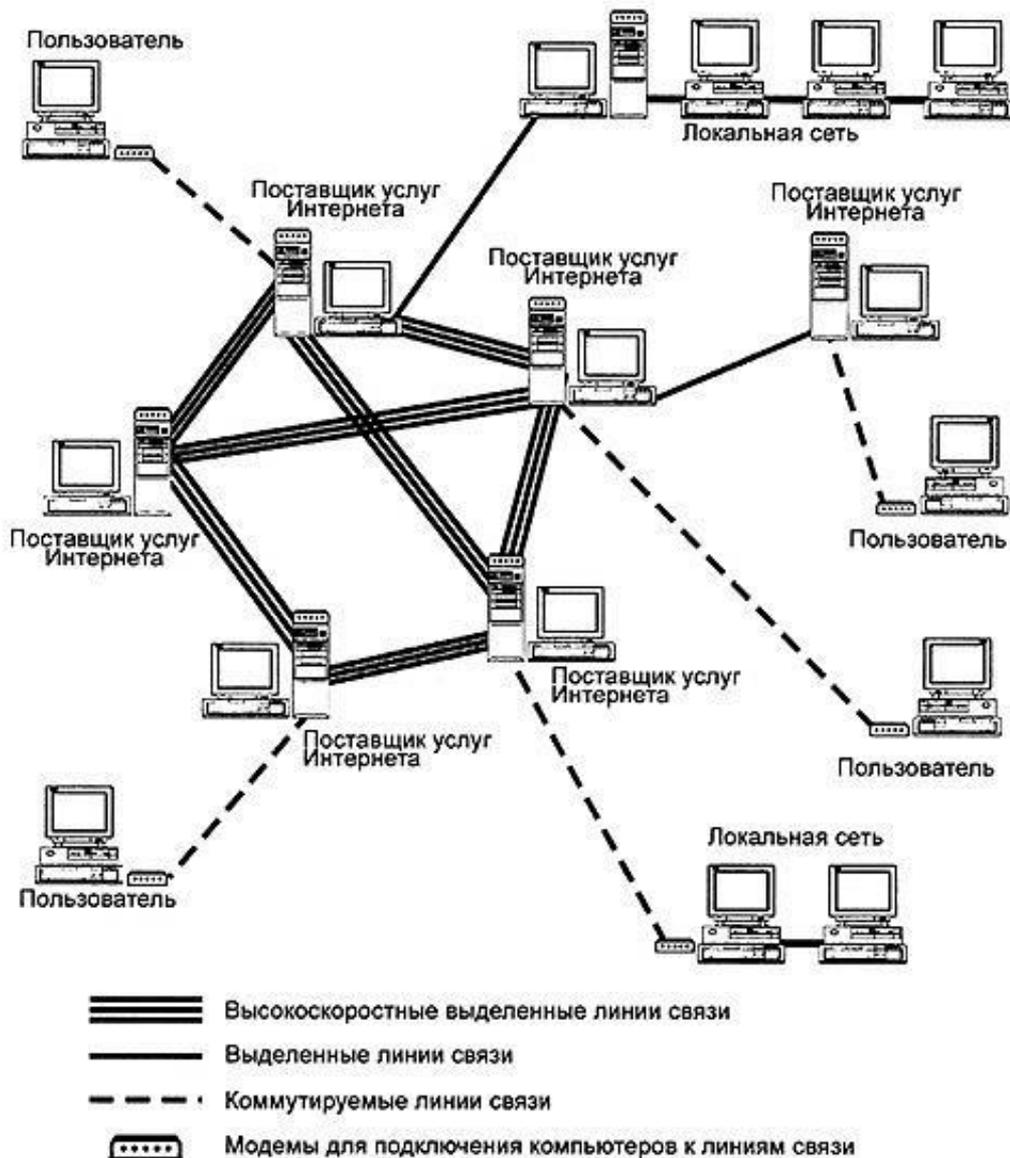
Компьютер пользователя с помощью линии связи подключается к компьютеру провайдера, который, в свою очередь подключен к другому компьютеру сети и т.д. Информация в сети хранится как на компьютерах провайдера, так и на специальных компьютерах, которые называются информационными серверами. Компьютеры, к которым подключаются многие другие компьютеры называют *серверами*. *Провайдером* называется организация, через которую рядовые компьютеры подключаются к глобальной сети.
