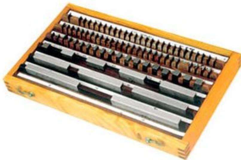
Концевые меры длины плоскопараллельные стальные.
