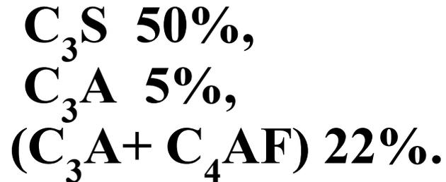
Сульфатостойкие портландцементы выпускаются *марок* 400 и 500. Согласно ГОСТ 22266–94 «Цементы сульфатостойкие. Технические условия», *условное обозначение* сульфатостойкого портландцемента складывается из условного обозначения цемента по ГОСТ 10178–85 (ПЦ, ШПЦ) и обозначения сульфатостойкости – «СС». *Пример условного обозначения бездобавочного сульфатостойкого портландцемента марки 400:*
