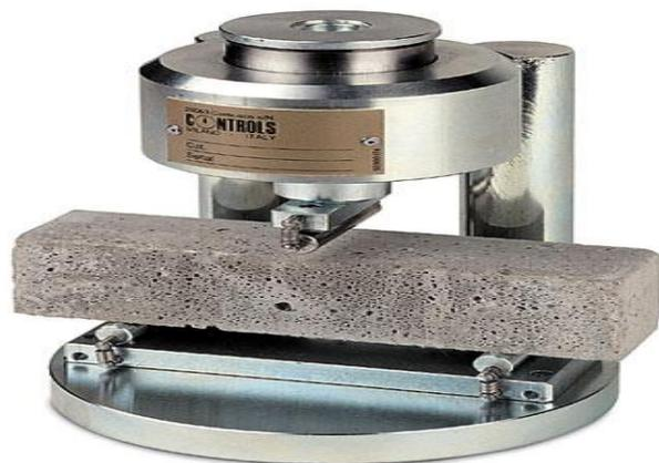
Предел прочности образца при изгибе (МПа) определяют по формуле:
