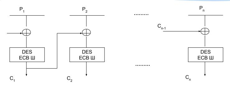
В режиме сцепления блоков CBC (Cipfer Block Chaining) шифротекст для каждого блока Сі получается путем зашифрования по базовому алгоритму, например, DES ECB, суммы по mod 2 соответствующего блока открытого текста и шифротекста предыдущего блока. IV — начальный вектор. DES ECB Ш — шифрование в режиме ECB. Для получения шифротекста первого блока используется начальный вектор IV вместо шифротекста предыдущего блока.
