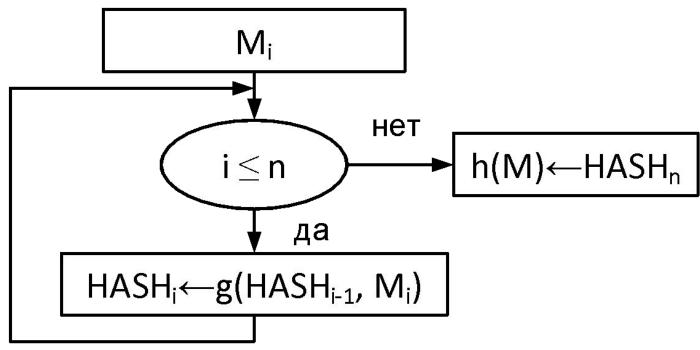
Схема вычисления значения хэш-функции для сообщения М= М1 М2...Мп.
