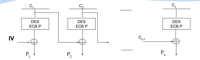
В режиме сцепления блоков СВС открытый текст для каждого блока Pi получается путем расшифрования по базовому алгоритму DES ECB P суммы по mod 2 соответствующего блока шифротекста текста и шифротекста предыдущего блока.
