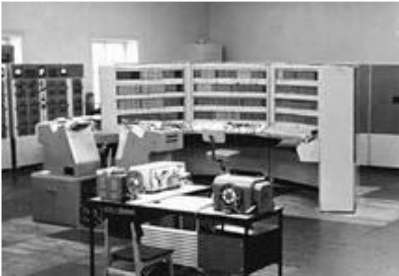
3-е поколение (начало 60-х гг.). Элементная база – интегральные схемы, многослойный печатный монтаж. Резкое снижение габаритов ЭВМ, повышение их надежности, увеличение производительности. Доступ с удаленных терминалов
