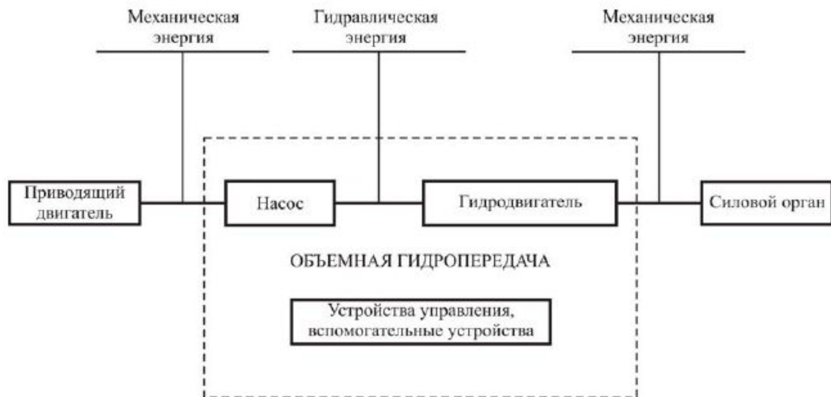
Рисунок 1.5 – Структурная схема гидропривода
