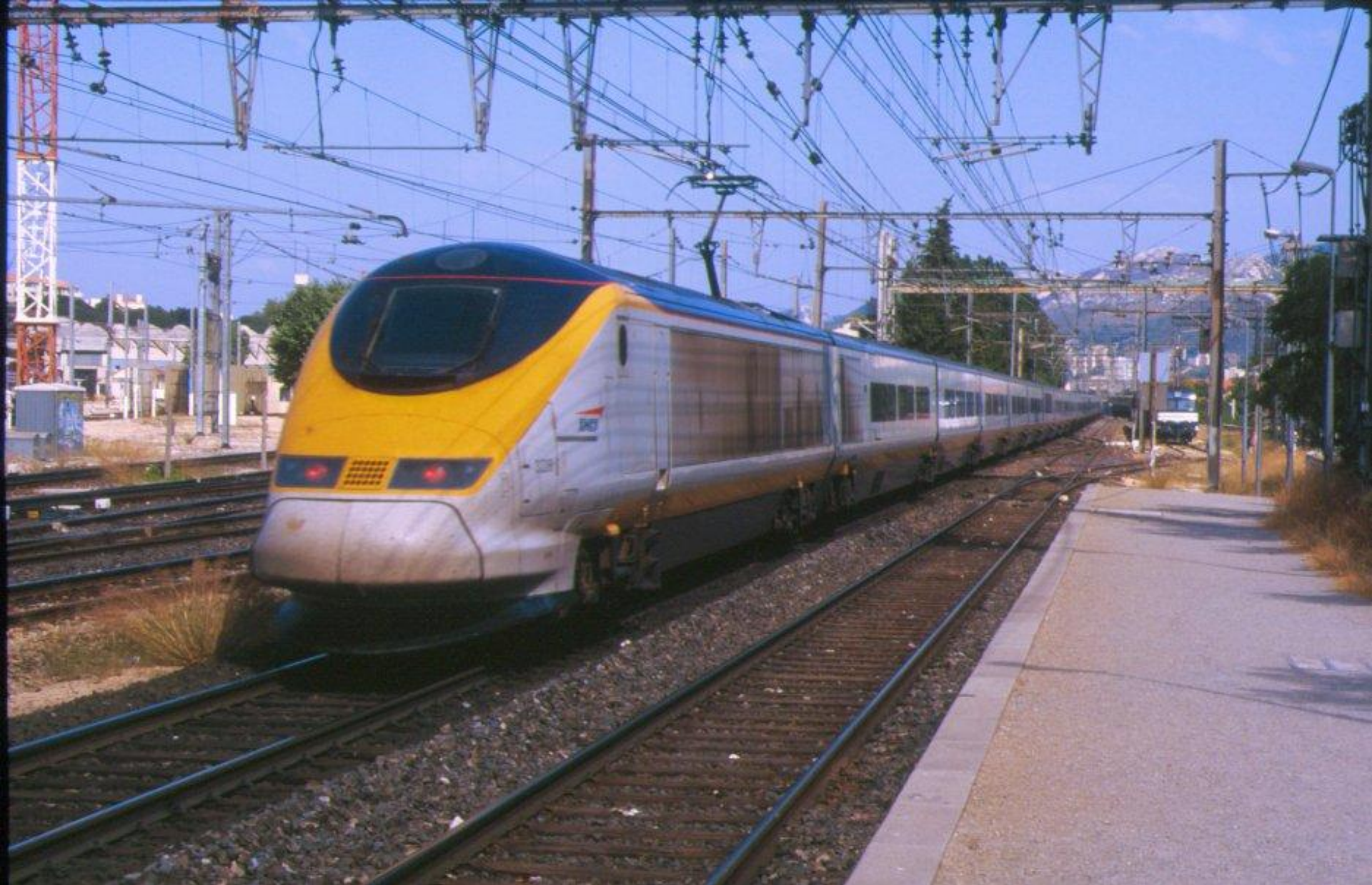
Поезд серии «TGV-T Eurostar» , выпускается с 1994 года, работает на маршруте Париж – Брюссель – Лондон, максимальная скорость – 300 км/ч
