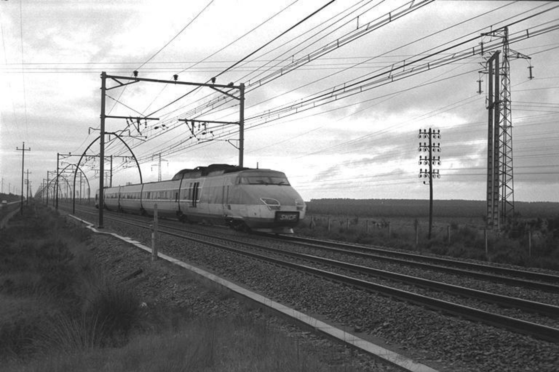
Первый французский высокоскоростной поезд с газотурбинным приводом и электрической передачей «TGV 001» 1972 г. п., скорость – свыше 300 км/ч
