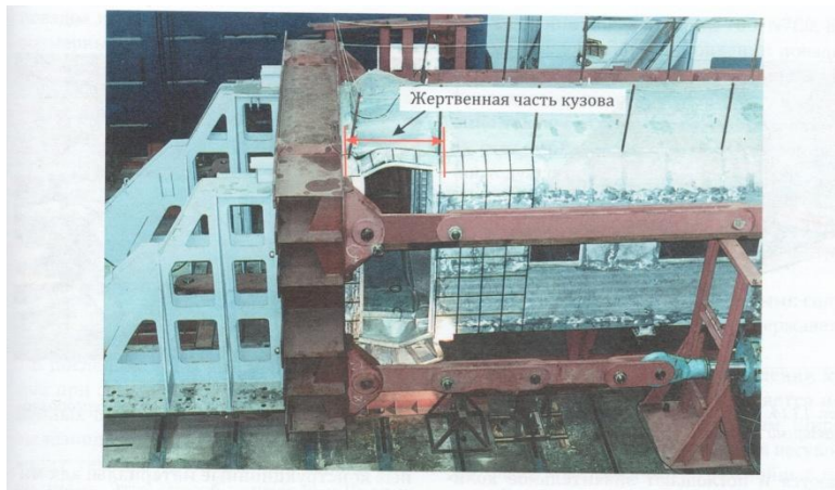
Высокоскоростной поезд V250 «Альбатрос» для железных дорог Бельгии и Нидерландов. Компания AnsaldoBreda. (Италия) 2009 г.: а — общий вид; б — конструкция носовой части головного вагона с устройствами поглощения удара
