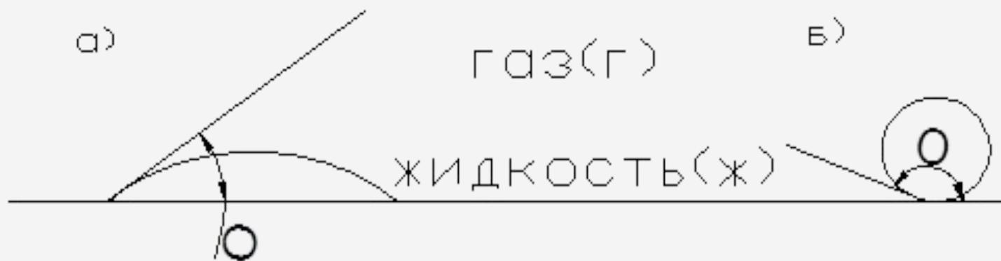
Краевые углы смачивания: а – смачивающая жидкость;
