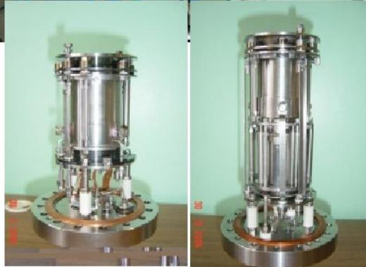
*Сеточные источники ионов позволяют обрабатывать поверхности со строго дозированным и направленным ионным воздействием и создавать поверхностные бездефектные наноструктуры .*
