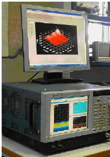
*Анализатор спектра реального времени (RTSA) серии RSA6100A может быть настроен на синхронизацию по событию, захват непрерывной во времени записи изменяющихся РЧ сигналов и анализ с временной корреляцией во всех областях.*
