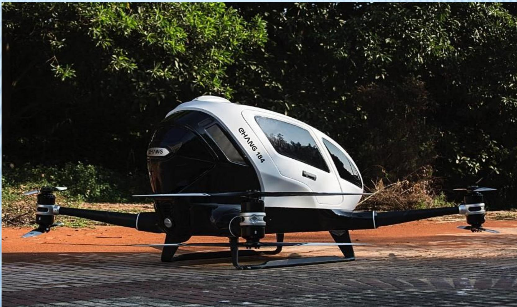
Предназначен для перевозки одного пассажира с багажом. Скорость полёта дрона 100 км/ч. Грузоподъёмность до 100 кг. В воздухе он может находиться 23 минуты. Один рейс с протяжённостью до 16 км.
