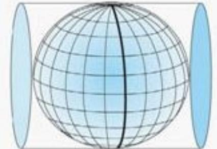
Рисунок. Поперечная цилиндрическая проекция
