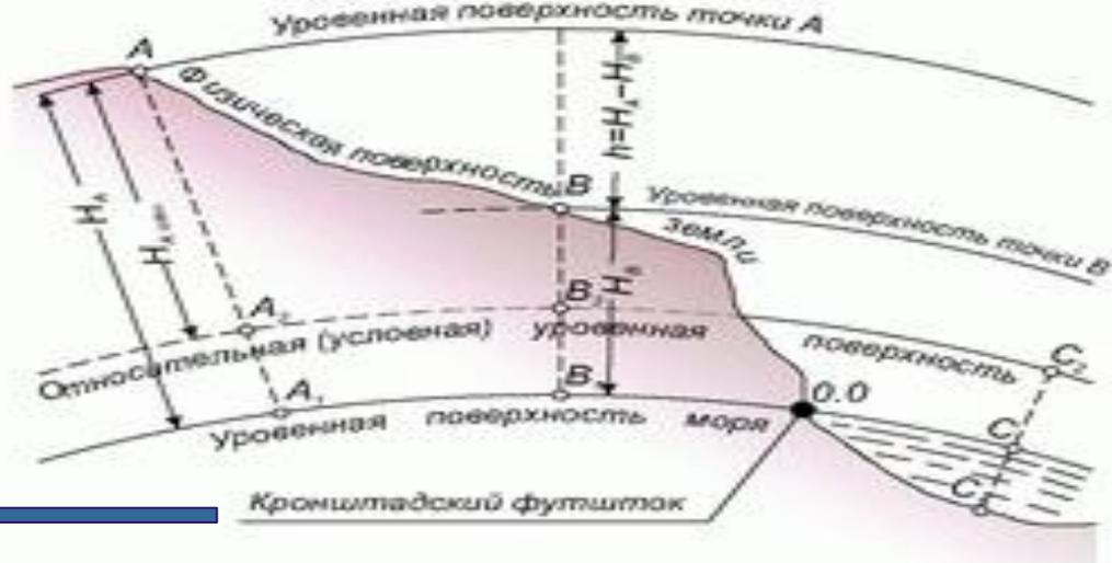
Отрезки AA<sub>1</sub>, BB<sub>1</sub>, CC<sub>1</sub> – представляют абсолютные отметки точек А, В, С
