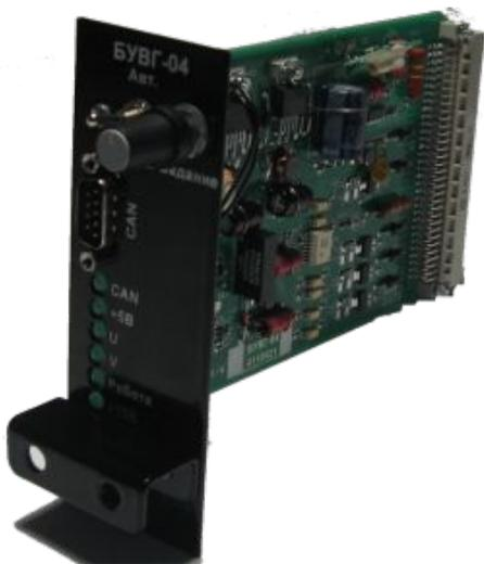
Блок управления возбуждением генератора управляет выпрямителем возбуждения, формирующим напряжение возбуждения дизель-генератора. Кроме того данный блок формирует сигналы управления тиристорами ослабления поля.
