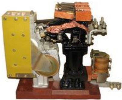
Контактор КМ1 (в тяговом режиме) шунтирует резистор RB1.
