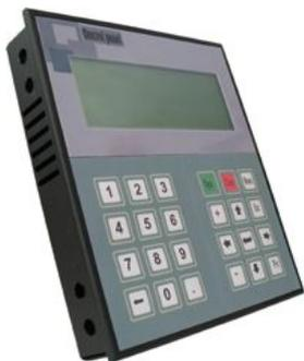
Панель оператора предназначена для отображения переменных системы управления, а также ввода цифровых данных с клавиатуры.
