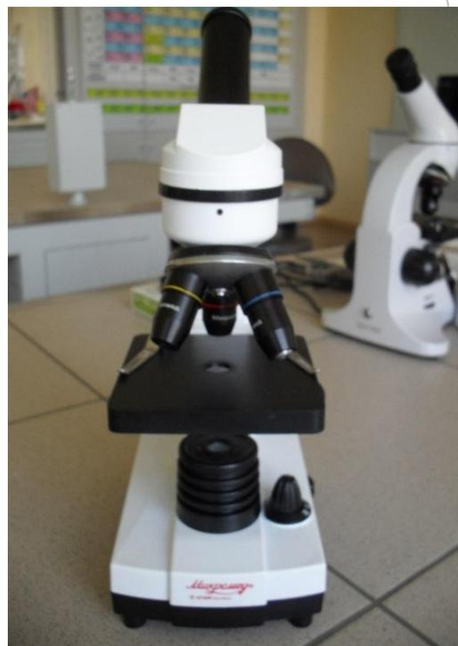
**Тубус** располагается на верхней части массивного штатива, включающего тубусодержатель.
