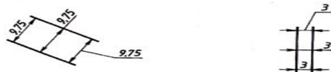
Рис. 44. Нанесение размерных чисел при недостатке места
