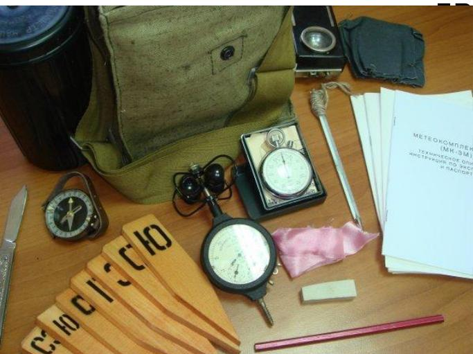
В **состав** комплекта входят: анемометр ручной, вымпела (защитного и белого цвета), азатели румбов (в чехле), термометр-пращ, компас, секундомер, шест складной (в чехле), рманный светосигнальный фонарь с батареей, рочинный нож, техническое описание, инструкция по эксплуатации комплекта и паспорт, рнал наблюдений, бланки метеодонесений, зинка, сумка для хранения и переноски комплекта.
