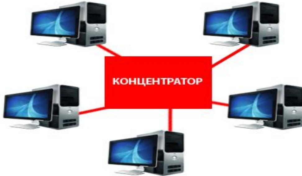
Топология «Звезда» схема соединения, при которой каждый компьютер подсоединяется к сети при помощи отдельного соединительного кабеля. Один конец кабеля соединяется с гнездом сетевого адаптера, другой подсоединяется к центральному устройству, называемому концентратором
