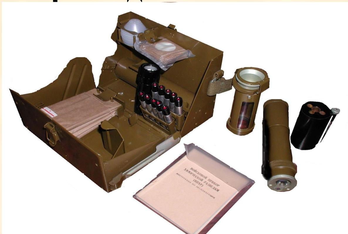
Войсковой прибор химической разведки (ВПХР) предназначен для определения в воздухе, на местности, на боевой технике зарина, зомана, иприта, фосгена, дифосгена, синильной кислоты хлорциана, а также паров VX, BZ, в воздухе.
