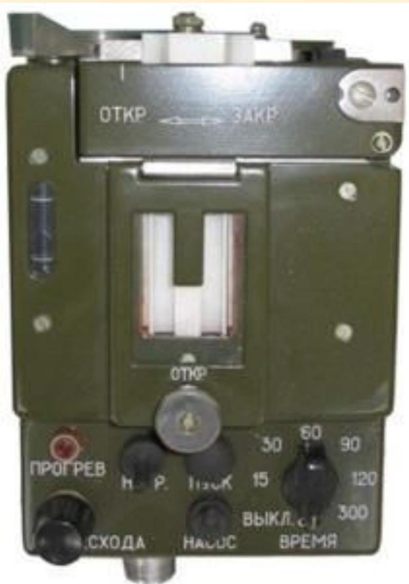
предназначен для периодического контроля зараженности воздуха, местности, боевой техники, обмундирования и снаряжения отравляющими веществами с помощью индикаторных трубок.
