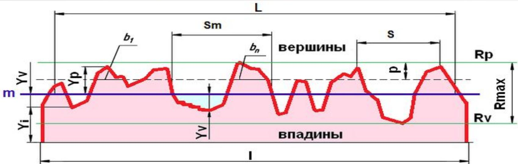
**Шероховатость поверхности** – это совокупность микронеровностей с относительно малым шагом в пределах базовой длины.
