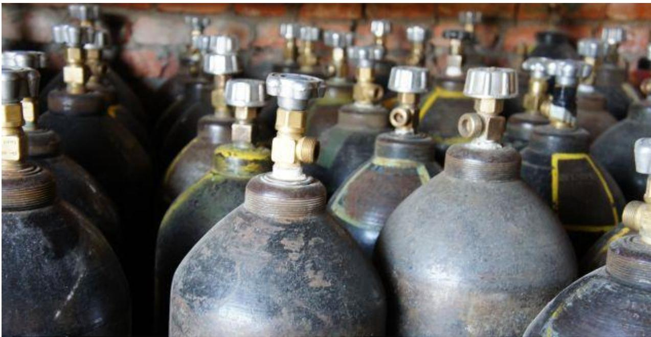
При спиртовом брожении образуется в качестве побочного продукта углекислый газ в количестве 96 % массы спирта. Этот газ улавливают и после очистки превращают в жидкую или твердую углекислоту. Выход продукта составляет 50...60 % теоретического. Производство углекислоты высокорентабельно.
