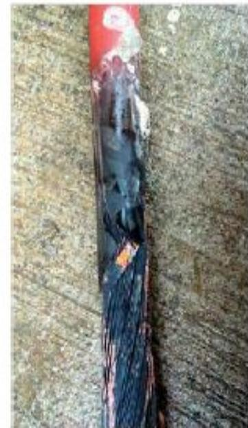
Поврежденная фаза кабеля, проложенного в стальной трубе
