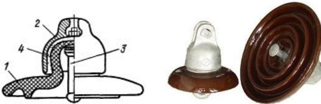
Подвесные изоляторы состоят из фарфоровой или стеклянной изолирующей части (1) и металлических деталей – шапок (2) и стержней (3), соединяемых с изолирующими элементами посредством цементной связки (4)
