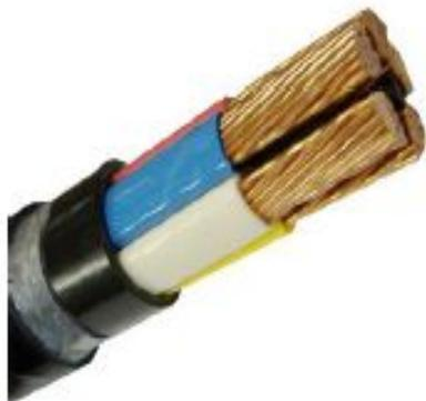
Кабели НН изготавливаются в основном в **4-жильном исполнении** (3 фазных проводника и один нулевой проводник для соединения с заземленной нейтралью), однако сейчас всё чаще используют **пятипроводную сеть** (3 фазы, нулевой проводник и защитное заземление от пробоя на корпус оборудования).
