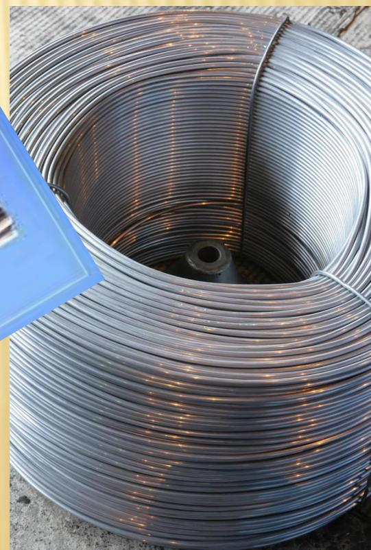
Желание повысить механическую прочность привело к изготовлению алюминиевых проводов со стальным сердечником, называемых *сталеалюминиевыми*.
