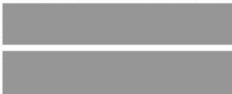
1.1 - разделяет транспортные потоки противоположных направлений и обозначает границы полос движения в опасных местах на дорогах; обозначает границы проезжей части, на которые въезд запрещен; обозначает границы стояночных мест транспортных средств;
