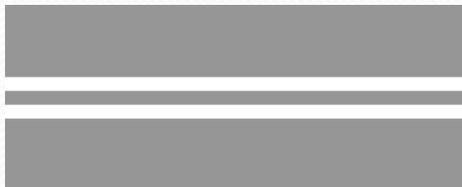
1.3 - разделяет транспортные потоки противоположных направлений на дорогах, имеющих четыре полосы движения и более; Линию 1.3 пересекать запрещается.
