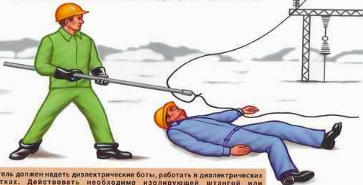
Спасатель должен надеть диэлектрические боты, работать в диэлектрических перчатках. Действовать необходимо изолирующей штангой или изолирующими клещами, рассчитанными на соответствующее напряжение. Остальные меры предосторожности те же, что и при низковольтной травме.
