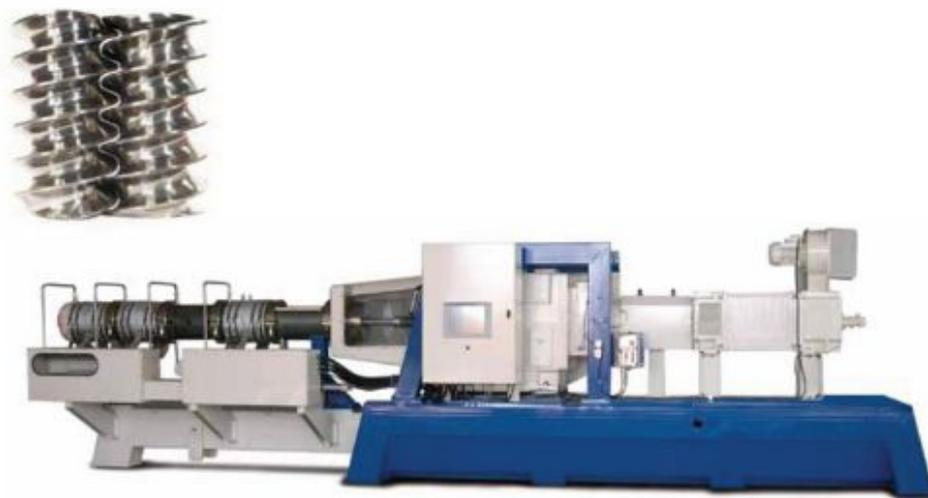
Двухшнековый экструдер, в основном, применяется для производства продуктов питания для человека (например, макаронные изделия, печенье и т.д.) По сравнению с одношнековой системой обеспечивает желатинизацию крахмала и смешивание ингредиентов на 25% выше. Конечным результатом является более низкая денатурации питательных веществ, что в свою очередь **повышает усвояемость готового продукта.**
