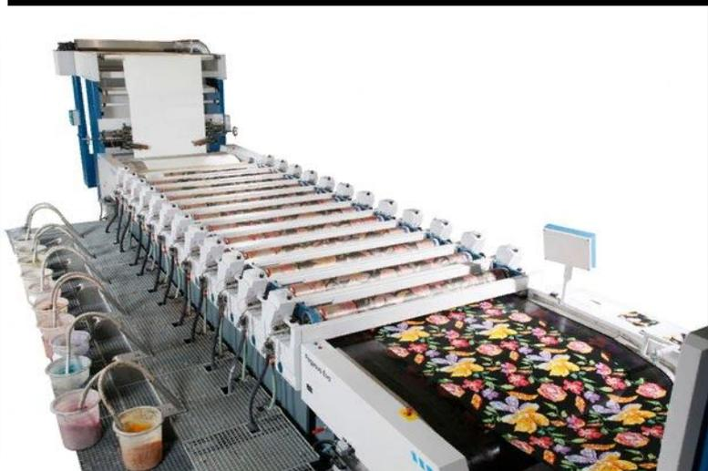
Ротационная печать сетчатыми шаблонами на ткани — ещё одна разновидность трафаретной печати. Из-за сложности изготовления цилиндрических трафаретов, этот способ печати встречается лишь на крупных предприятиях текстильной промышленности.
