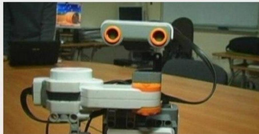
12-летний Максим Лема из Львова создал робота, выполняющего функции инженеров БТИ (замерщиков). Робот сканирует помещение, замеряет площадь, составляет план и с помощью радиосигнала передает данные на компьютер.
