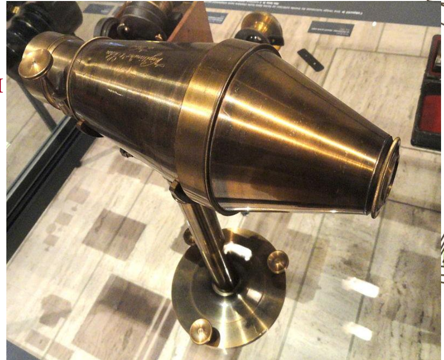
Современная копия дагеротипной камеры «Фохтлендер» 1841 года выпуска
