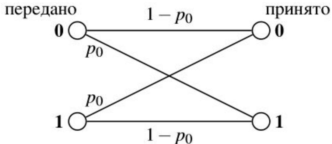
Рис.2. Модель двоичного симметричного канала
