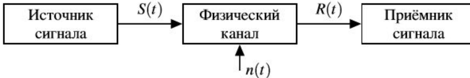
*Рис.1. Структурная схема физического канала в общем виде*
