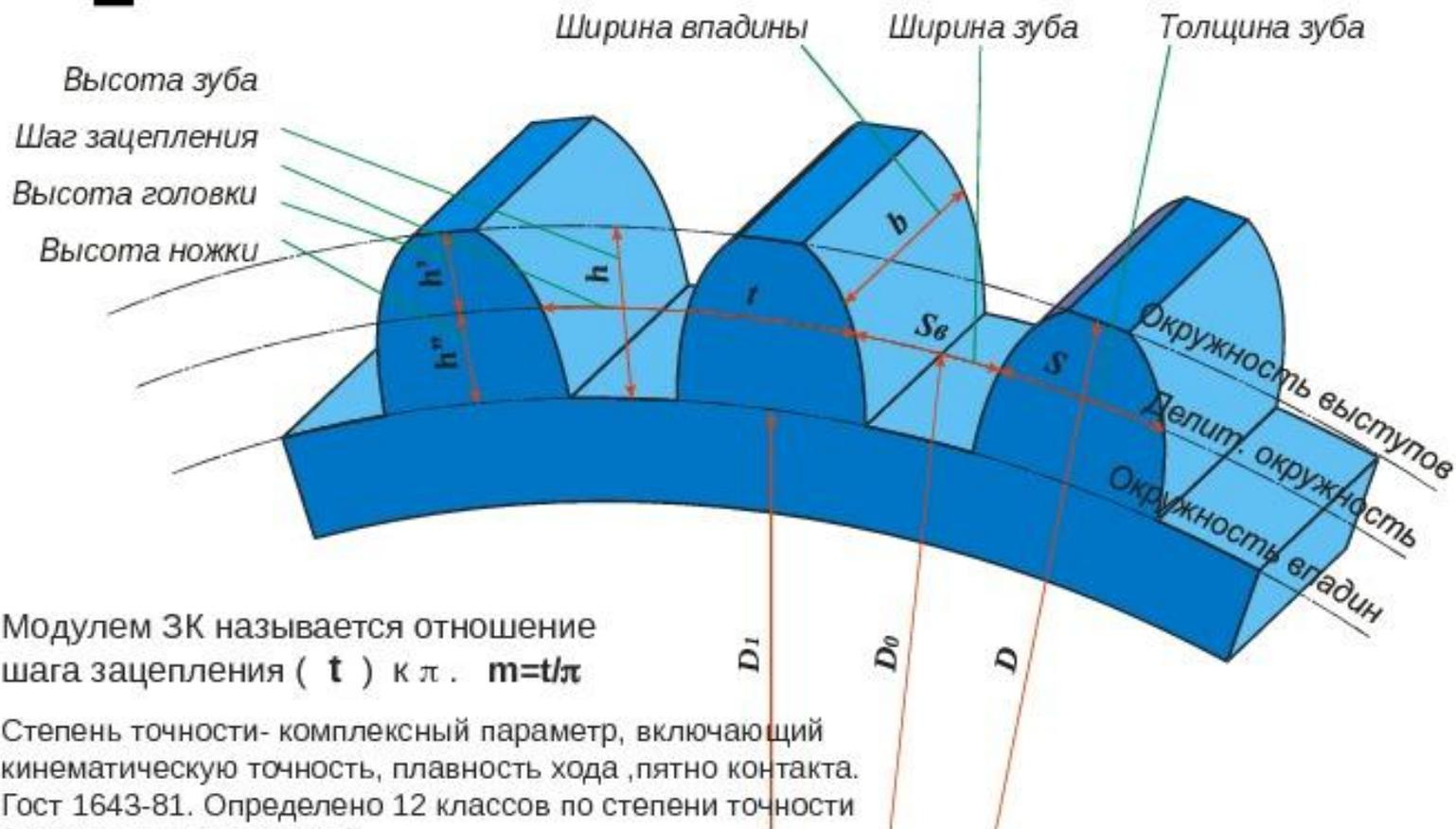
Модулем ЗК называется отношение шага зацепления ( $t$ ) к  $\pi$ .  $m = t/\pi$
