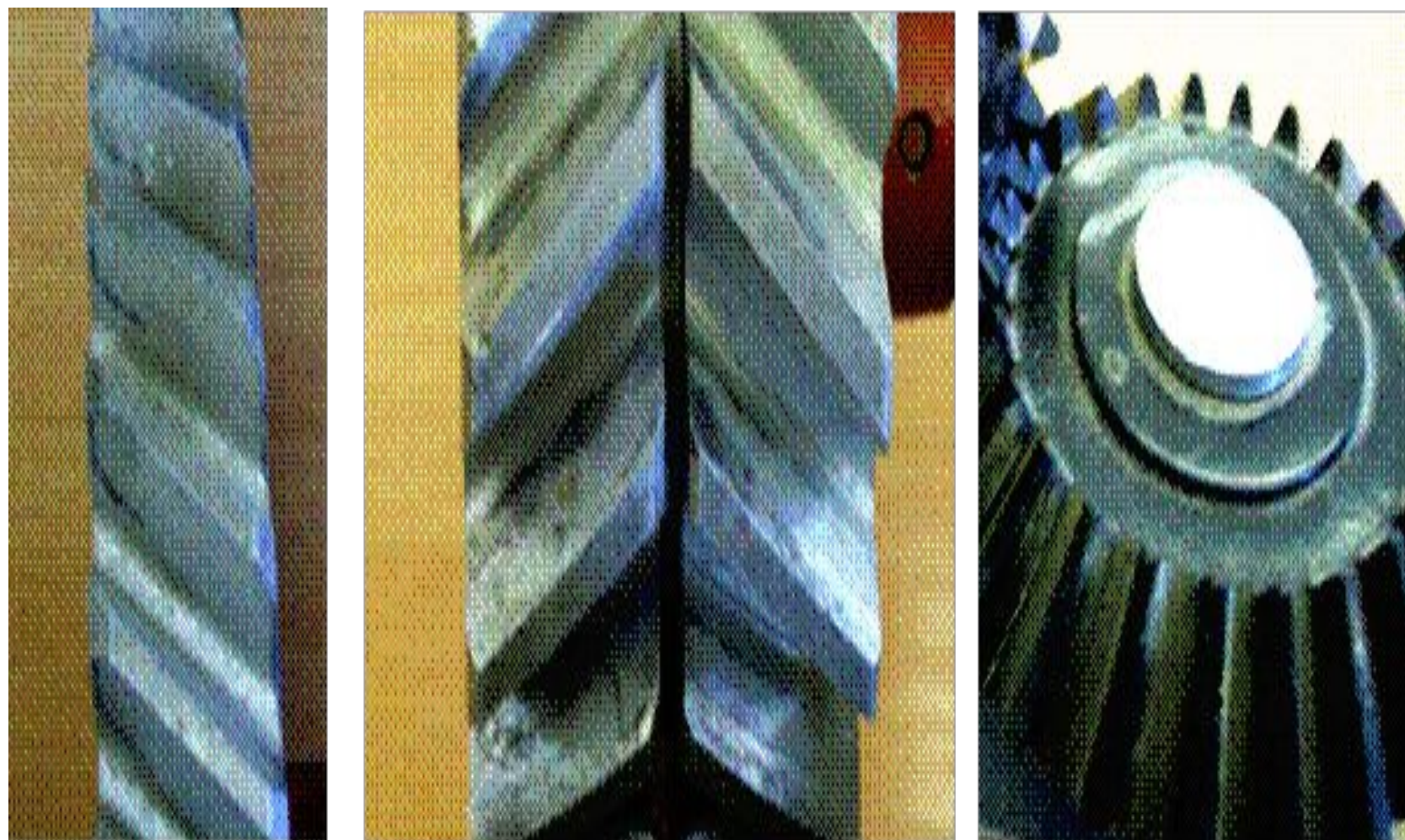
Рис. 5. Виды зубчатых колес: цилиндрическое косозубое (слева), шевронное (в центре), коническое прямозубое
