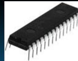
Распайку микросхемы производить при температуре 200 градусов, продолжительностью 2 секунды.
