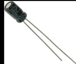
Конденсаторы, резисторы паять при температуре жала паяльника не более 265 градусов по Цельсию, время пайки 2-3 секунды.
