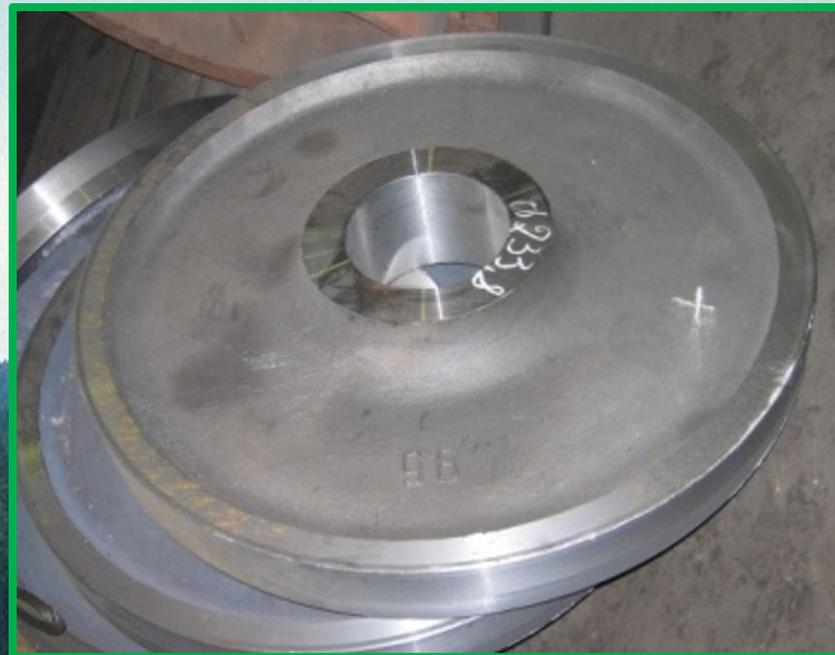
Наружная часть колесного центра (обод) диаметром 900 мм соединена со ступицей диском, в котором имеются два отверстия диаметром 45 мм, используемые для транспортировки колесной пары и крепления ее при обточке на токарном станке.
