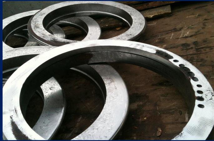
Перед насадкой бандажа на обод колесного центра его нагревают до температуры  $250 - 320\text{ }^{\circ}\text{C}$ , чтобы обеспечить натяг  $1,0 - 1,5\text{ мм}$ . В горизонтально расположенный бандаж опускают установленный на оси колесный центр до упора в борт бандажа
