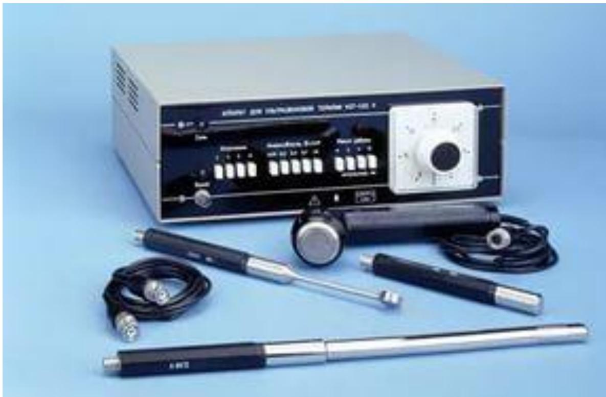
**Пьезоэлектрический эффект** положен в основу излучателей, изготовленных из пластин кварца, турмалина и других материалов которые под воздействием переменного электрического тока меняют свои размеры и вызывают механические колебания среды ультразвуковой частоты.
