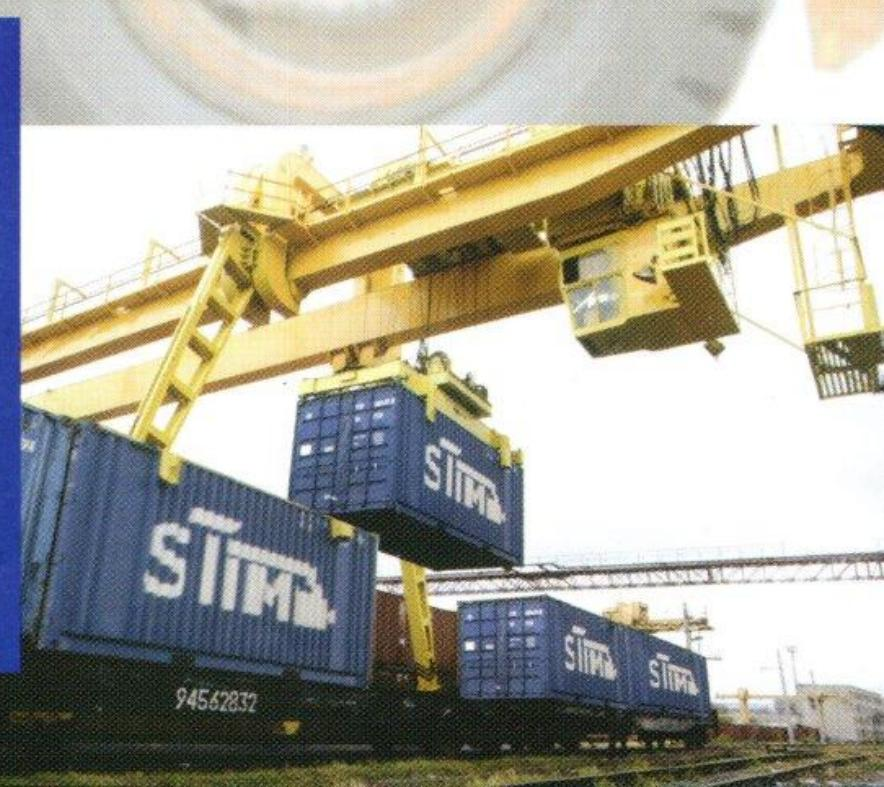
**Универсальный контейнер** — унифицированная грузовая единица, предназначенная для перевозки тарно-штучных грузов, представляющая собой стандартизированную по максимальной массе брутто, габаритным размерам конструкцию, снаженную стандартизованными по форме, содержанию и месту расположения: надписями, табличками и оборудованную, приспособлениями для закрепления на различных видах транспортных средств и механизации погрузочно-разгрузочных работ.
