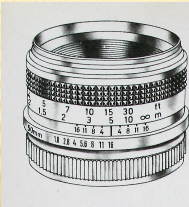
Во многих камерах фокусирующий механизм представляет собой винтовую нарезку с большим шагом, встроенную в оправу объектива. Шкала расстояний имеет обычно отметки и в метрах, и в футах (1 фут  $\approx$  30 см) и снабжена шкалой глубины резкости. Данный объектив установлен на расстоянии до объекта 5 м, величина диафрагмы 1:16. Шкала глубины резкости показывает, что в этом случае резкими получаются все объекты, расположенные от объектива на 2,5 м и до бесконечности.
