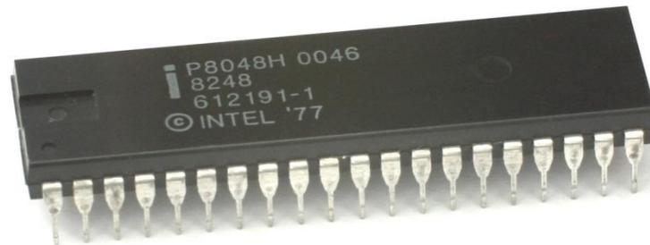
Это была микросхема фирмы **Intel**, получившая имя **i8048**.
