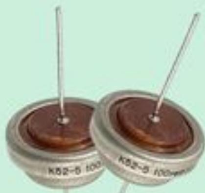
Оксидно-электролитический объёмно-пористый танталовый конденсатор
