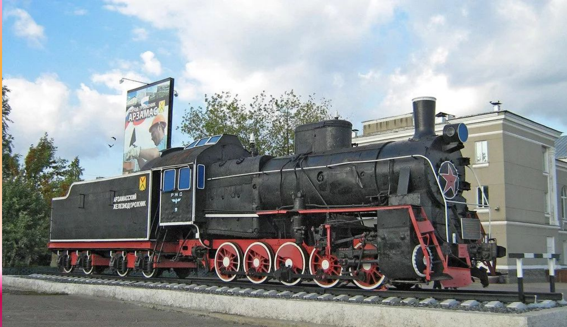
Установленный в качестве памятника паровоз серии Эр изготовлен на венгерском заводе МАВАГ в Будапеште в 1953 году. Масса паровоза в рабочем состоянии - 85 тонн, конструкционная скорость - 65 км/ч.
