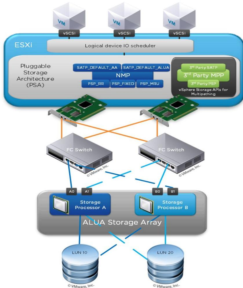
Подобная схема позволяет повысить надежность и одновременно распределить нагрузку между узлами СХД и серверами виртуализации
