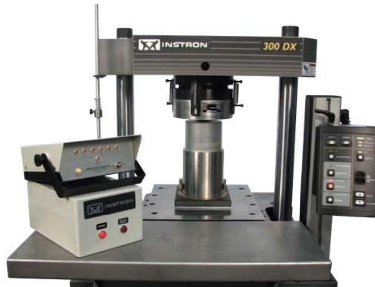
Машина для проведения испытаний на сжатие, изгиб и сдвиг с высокой нагрузочной способностью фирмы Instron
