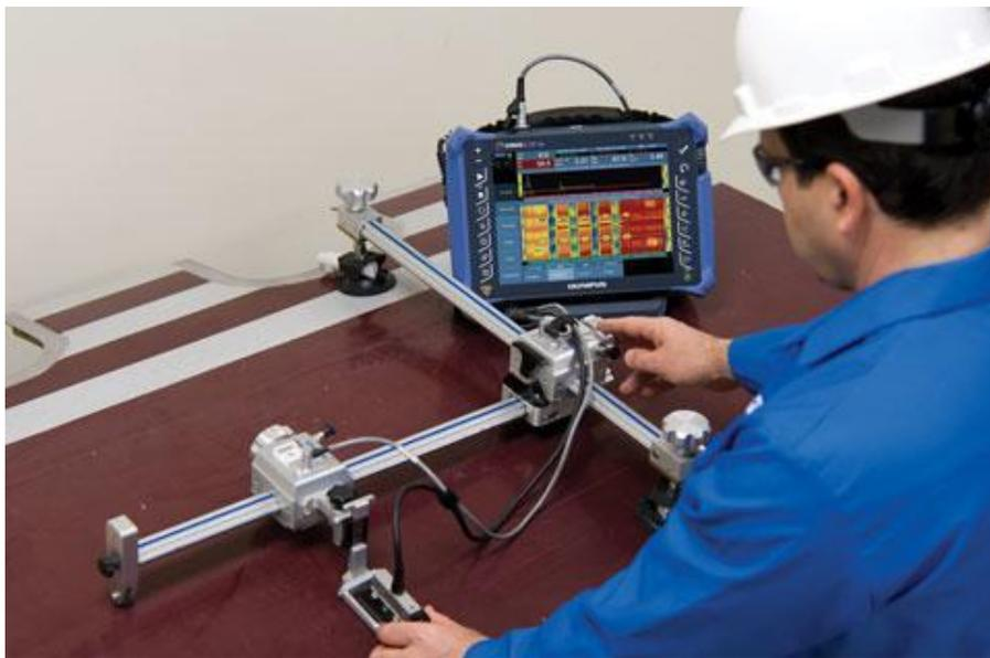
Дефектоскоп OmniScan®, сканер GLIDER™, роликовый преобразователь RollerFORM™ и кодировщик Mini-Wheel.
