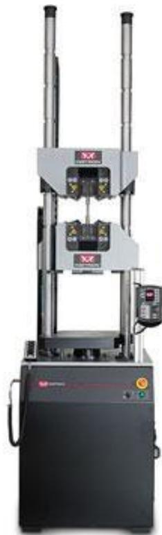
Машина для проведения испытаний на растяжение, сжатие, изгиб и сдвиг с высокой нагрузочной способностью
