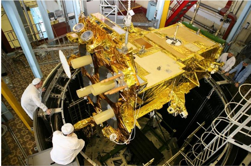
Космический аппарат «Луч-5А» в термовакуумной камере, АО «ИСС им. М.Ф. Решетнева», г. Железногорск, Красноярского края.
