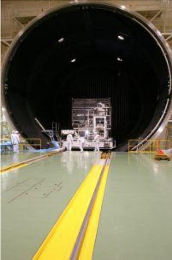
Термовакуумные испытания представляют собой разновидность стендовых испытаний.
