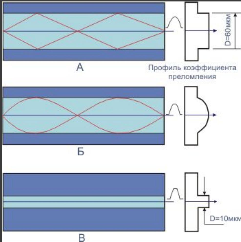
Разновидности оптических волокон, отличающиеся зависимостью
